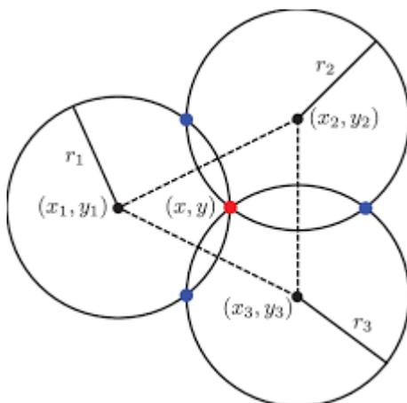
Le point à localiser est situé en rouge sur la figure point de concours des trois cercles fronts d'onde (lieu des points de même amplitude du signal) des signaux émis (ondes sphériques) par les 3 satellites.
